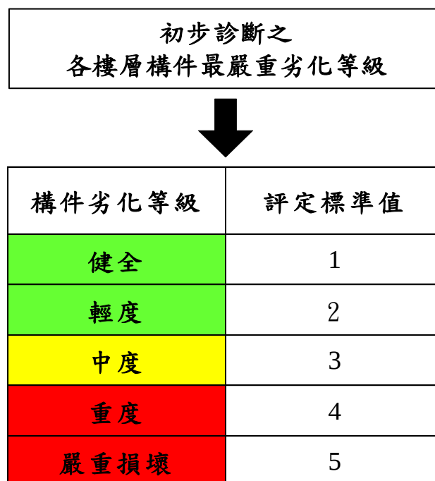
圖 2.19 構件劣化評定標準[2.4]
